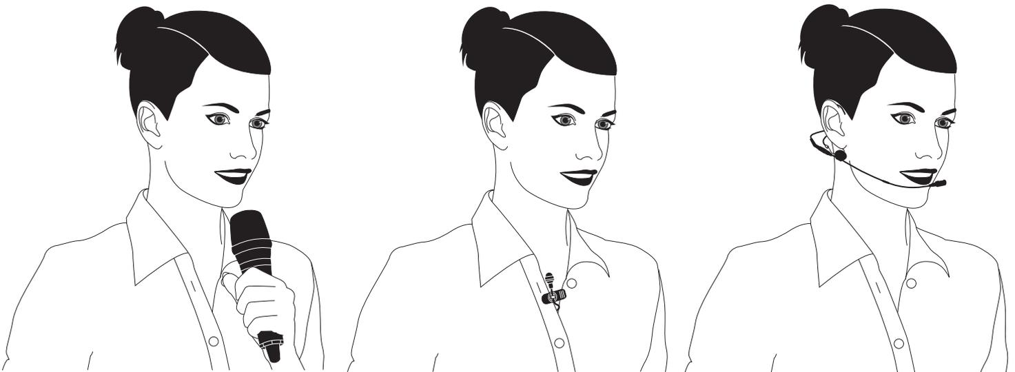
Zur Wahl stehen dynamische und Kondensator-Mikrofonköpfe, die als Hand-, Ansteck- oder Headset-Mikrofone eingesetzt werden können.
